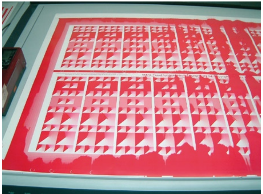
Abb. 5: Ungleichmäßiges Tönen der Testform verursacht durch ein falsch eingestelltes Feuchtwerk [s. Abb. 6].
