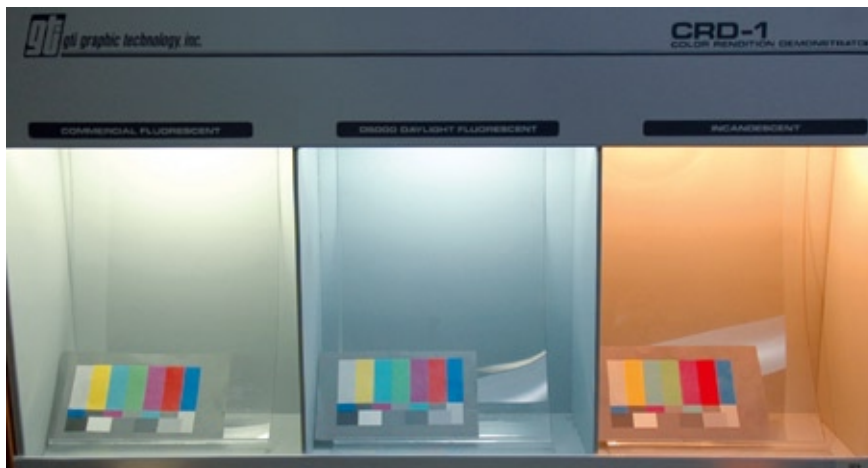
Abb. 1: Identische Drucke unter drei verschiedenen Lichtarten [links: Bürolicht – „Cool white Fluorescent“, Mitte: Normlichtart D50 gemäß ISO 3664, rechts: Glühlampe].
