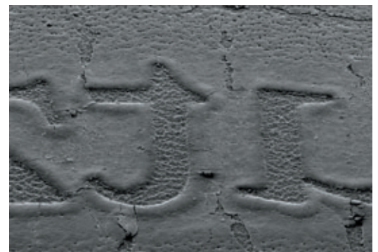
REM-Aufnahme von weißem Belag auf bildfreien Stellen („Negativ-Aufbauen“) der untersuchten Drucktücher.
