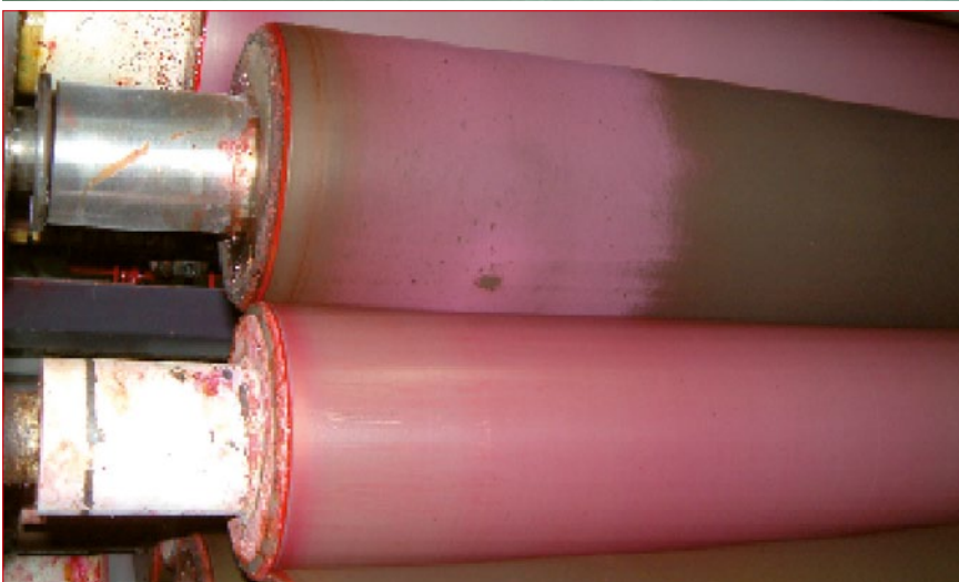
Abb. 3 (oben) und Abb. 4 (unten): Der Druck der Testform (oben) zeigt das deutliche Defizit im Farbwerk (unten) an.
